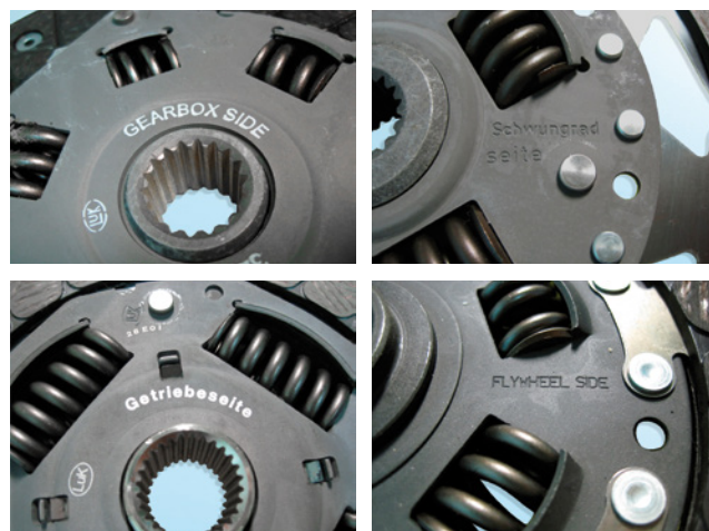
Fig. 1-4: posibles inscripciones sobre el disco de embrague
