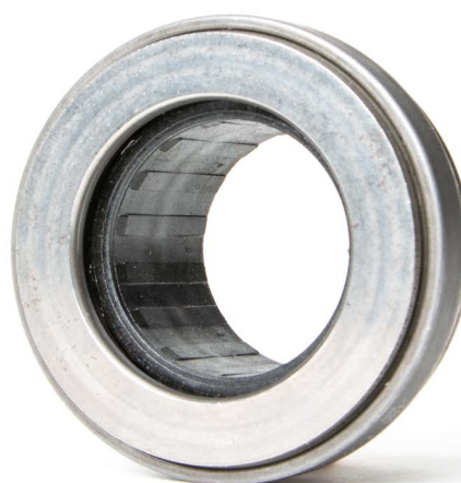
Obrázek 2: Vypínací ložiska s plastovými pouzdry se nesmí mazat mazivem
