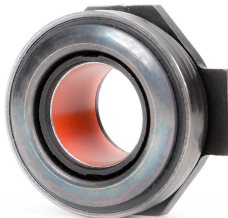
Obrázek 3: Vypínací ložiska s pouzdry s potahem PTFE se nesmí mazat mazivem
